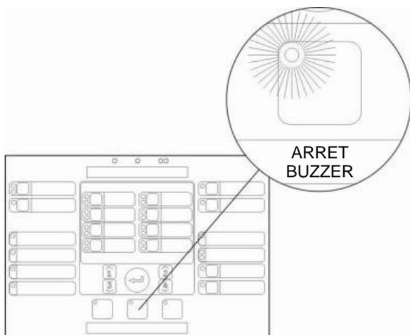
La LED Arrêt buzzer s'allume et le buzzer s'arrête. De nouveaux événements d'alarme ou de dérangement vont réactiver le buzzer.
