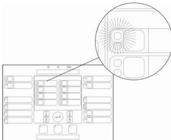
Si les LED d'alarme incendie et d'alarme de zone clignotent, l'alarme incendie a été activée par un détecteur. Si elles sont fixes, l'alarme incendie a été activée par un bouton-poussoir d'alerte.
